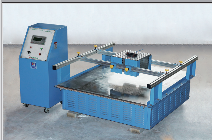
Machine d'essai aux vibrations
