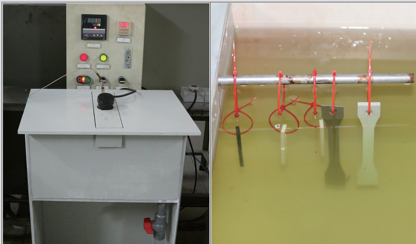
Bain d'essai de la résistance à la corrosion au chlore réalisé dans notre laboratoire
